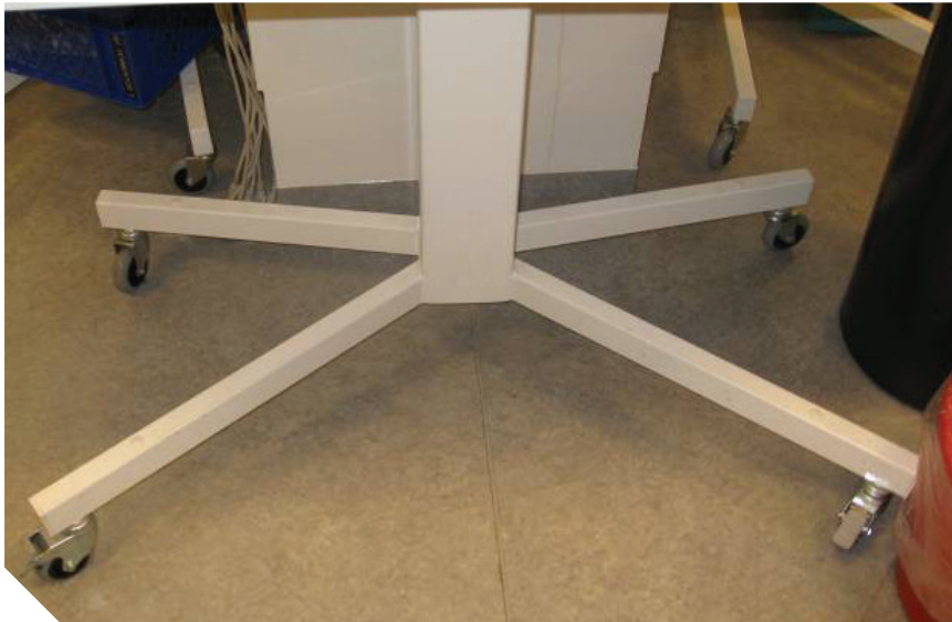
Godt arbejdsbord til laboratorier, der desværre har H/S aktuatorer i benet, som er vendt forkert.
