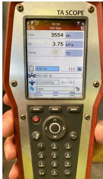
Illustration nr. 2 herover viser et eksempel på dokumentation for udført performancetest. TA-SCOPE er brugt til selve indreguleringen og bruges igen til de stikprøver som indgår i performancetesten.
