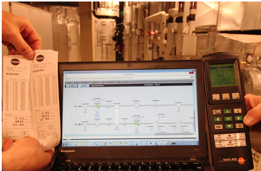
Illustration nr. 3 herover og 4 herunder. Foto fra igangværende performancetest, hvor der udføres stikprøvekontrol mht sammenhæng mellem anlægsopbygning, anlægsbillede, instrumentering, følerøjagtighed og logninger.
